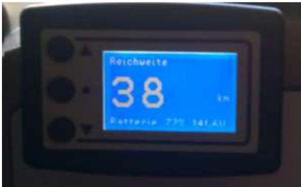
Es wird die verbleibende Reichweite in Kilometer bzw. Meilen angezeigt. Dabei wird der durchschnittliche Stromverbrauch seit dem letzten Reset des TWIZPLAY for SAM zugrunde gelegt. Kurz nach dem Reset ist die Vorhersage noch ungenau, stabilisiert sich aber nach einigen Kilometern. Durch den Reset haben Sie es in der Hand, dass sich TWIZPLAY for SAM schneller auf geänderte Betriebsbedingungen einstellt, z.B. nach einem Temperatursturz oder nach einem Räderwechsel.
