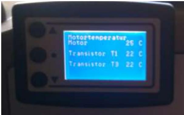
Der Screen zeigt die Wicklungstemperatur des Motors und die Temperatur zweier Leistungstransistoren an.
