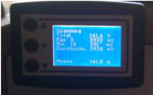
Der Screen zeigt die Gesamtspannung der Batterie sowie die Zelle mit der höchsten Zellspannung und der niedrigsten Zellspannung an. Die Zellnummern sind angegeben. Weiterhin sind die durchschnittliche Spannung aller Zellen und die Spannung am Motor angegeben. Bitte beachten Sie: Während des Ladevorgangs wird keine Motorspannung angezeigt. Bei der Fahrt mit Antrieb ist die Spannung am Motor niedriger als die Spannung der Batterie, bei der Rekuperation ist es umgekehrt.
