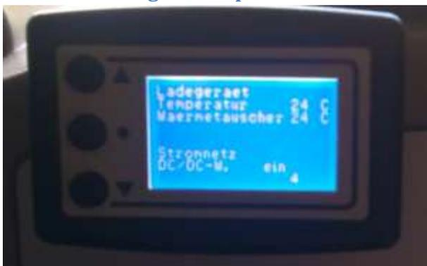
Der Screen zeigt die Temperatur des Ladegeräts sowie des dazugehörigen Wärmetauschers zum Kühlsystem an. Weiterhin ist angegeben, ob der im Ladegerät integrierte DC/DC-Wandler eingeschaltet ist.
