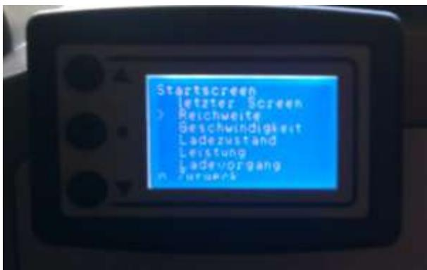
In diesem Untermenü wird eingestellt, mit welchem Screen TWIZPLAY for SAM beim Einschalten der Zündung starten soll. Bei der Wahl „letzter Screen“ startet TWIZPLAY for SAM immer mit dem Screen, der nach dem Ausschalten der Zündung und dem Nachlauf des Display eingestellt war. Hinweis: Das automatische Einschalten des Screens 5 „Ladevorgang“ während des Ladens hat keinen Einfluss auf den letzten Screen, da dabei ja nicht die Zündung ausgeschaltet wird.
