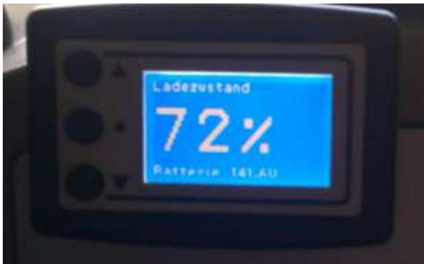
Anzeige des Ladezustands (SOC – state of charge) in Prozent. Zusätzlich ist darunter die Batteriespannung angezeigt.
