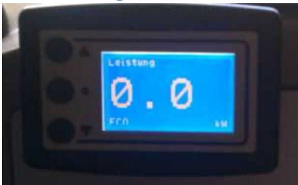
Der Screen zeigt die der Batterie entnommene Leistung in Kilowatt an. Die Anzeige ist positiv bei Stromentnahme und negativ bei der Rekuperation oder beim Laden.
