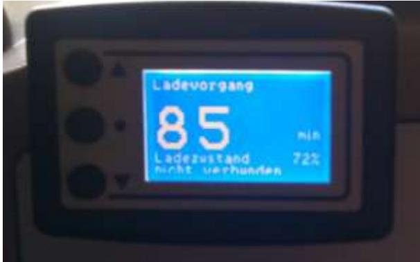
Der Screen zeigt eine ungefähre Vorhersage der Ladedauer bis zur Vollladung an. Der Wert dient nur zur groben Abschätzung, denn gegen Ladeende sinkt die Ladeleistung und der Ladevorgang würde bis tatsächlichen Vollladung (grüner Balken im Tacho mit Dauerlicht) sehr lange dauern. In der Praxis wird der Ladevorgang sowieso meist vorher beendet.
